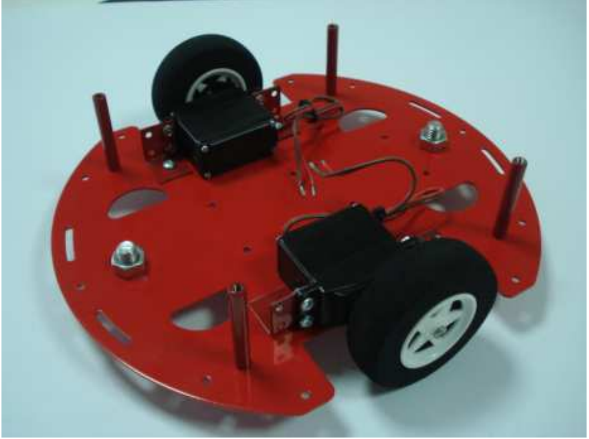
Şekil 11 Alt şasinin tamamlanmış durumu.
