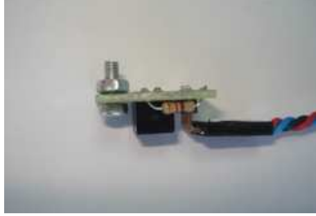
Şekil 3 Çizgi algılayıcıya vida ve somunun bağlantısı.
