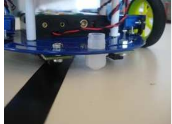
Şekil 10 Çizgi izleyen robotun çizginin soluna kaymış durumu: sağ taraftaki algılayıcı çizginin üzerindedir.
