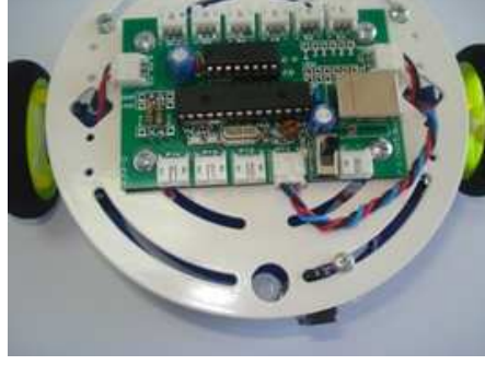
Şekil 5 Algılayıcının O-bOt kontrol kartına bağlantısı.
