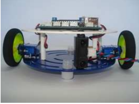
Şekil 3 Uzaklık algılayıcının O-bOt'a yerleştirilmesi.
