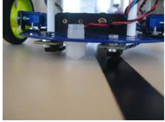
Şekil 9 Çizgi izleyen robotun çizginin sağına kaymış durumu: sol taraftaki algılayıcı çizginin üzerindedir.
