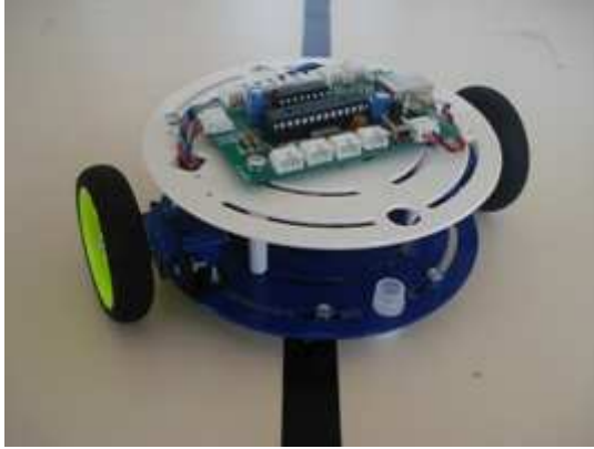
Şekil 10 Çizgi izleyen robotun çizginin soluna kaymış durumu: sağ taraftaki algılayıcı çizginin üzerindedir.
