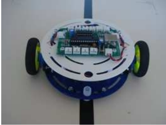
Şekil 8 Çizgi izleyen robotun düz durumu: çizginin sağ ve solunda yer alan algılayıcılar çizgiyi algılamazlar.
