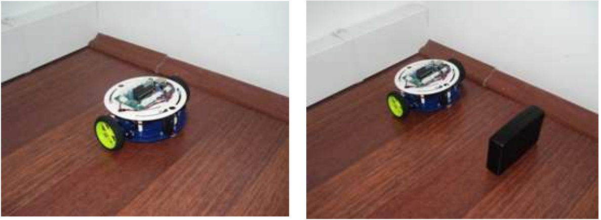
Şekil 1 O-bOt'un duvarı takip etmesi ve engellerden kaçınması.
