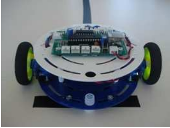
Şekil 11 Çizgi izleyen robotun çizginin sonunda durdurulması: sol ve sağ taraftaki algılayıcılar siyah çizgi üzerindedir.
