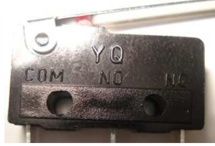
Şekil 10 O-bOt Kontrol Kartı P5..10 mikroanahtar için örnek bağlantı şekli ve bir mikroanahtar.
